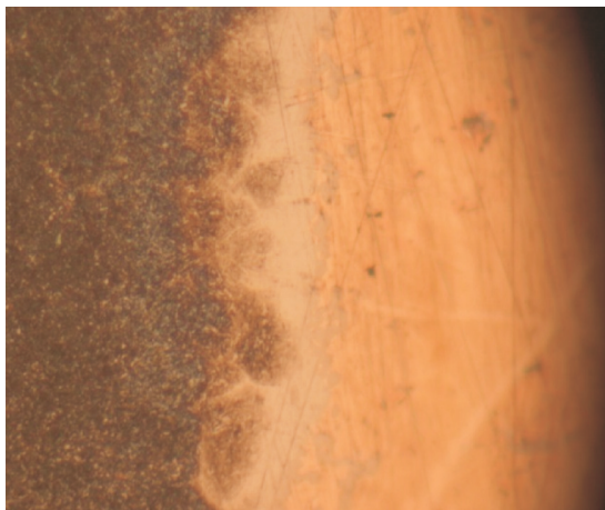
Рис. 3. Микроструктура качественного сварного соединения сталь — бронза (при увеличении \times 1000 )
