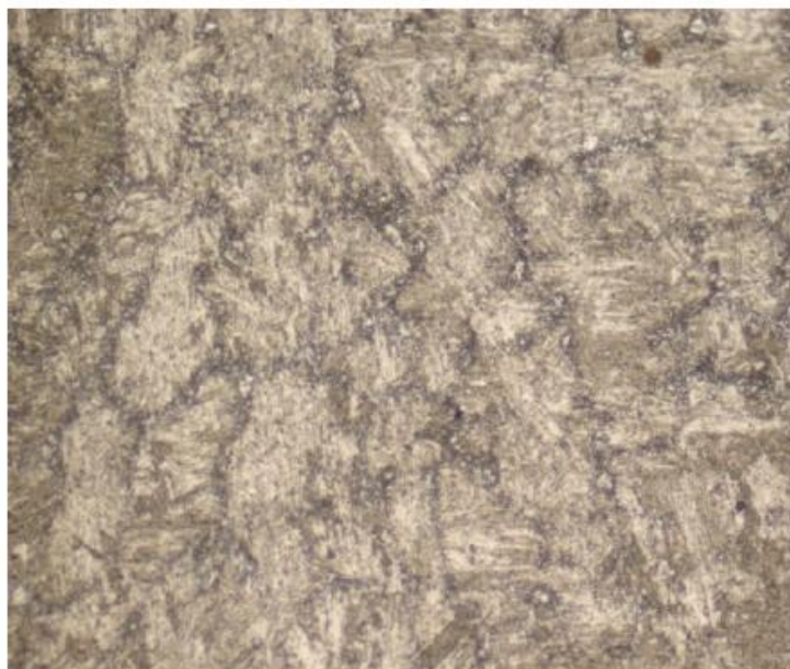
Микроструктура металла после старения (x500)
