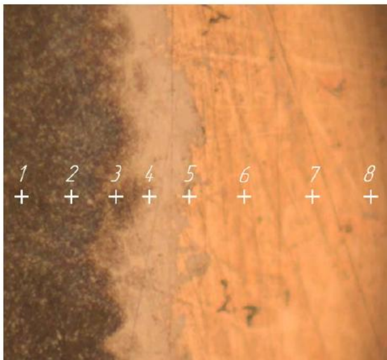
Микроструктура полученного сварного соединения (x1000) с точками ЭДА
