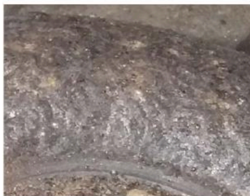
Рис. 2. Шлаковая корка на поверхности наплавленного слоя
