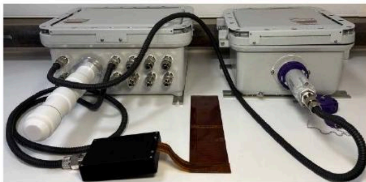
Рис. 1. Система волноводного мониторинга состояния трубопроводов и листов
