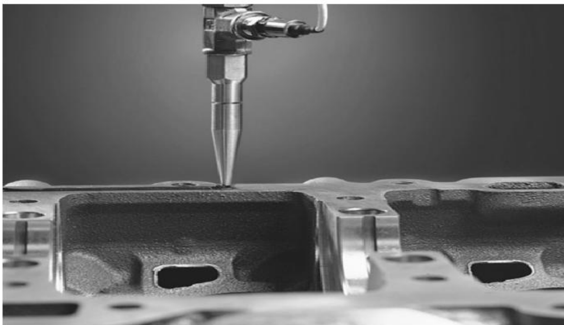
Рис. 1. Нанесение уплотнений (Gasketing)
