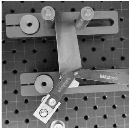
Рис. 2. Лопатка, закрепленная прижимами
