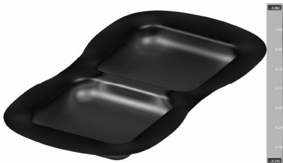
Рис. 3. Утончение заготовки при вытяжке
