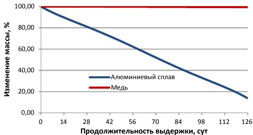
Рис. 3. Изменение массы образцов из алюминиевого сплава и меди в течение 126 суток в среде 1%-го раствора HF
