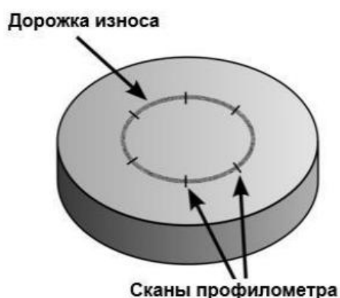
Рис. 2. Схематическое изображение дорожки износа и измерения с помощью поверхностного профилометра (сканы)
