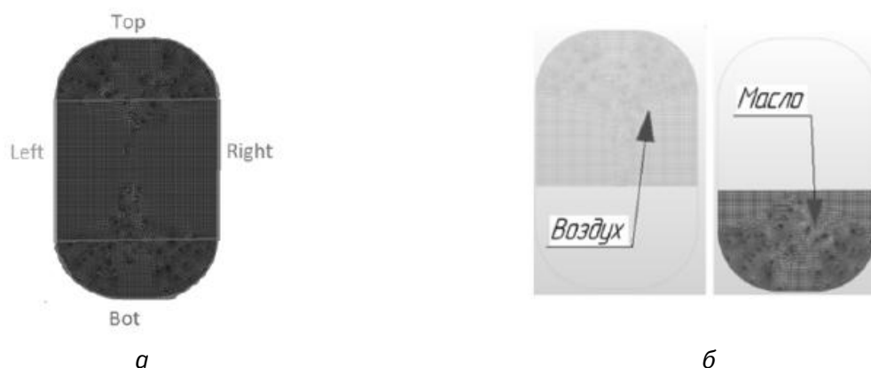
Рис. 4. а — деление поверхности галереи; б — начальное положение сред
