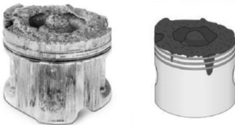
Рис. 1. Расплавление дна поршня
