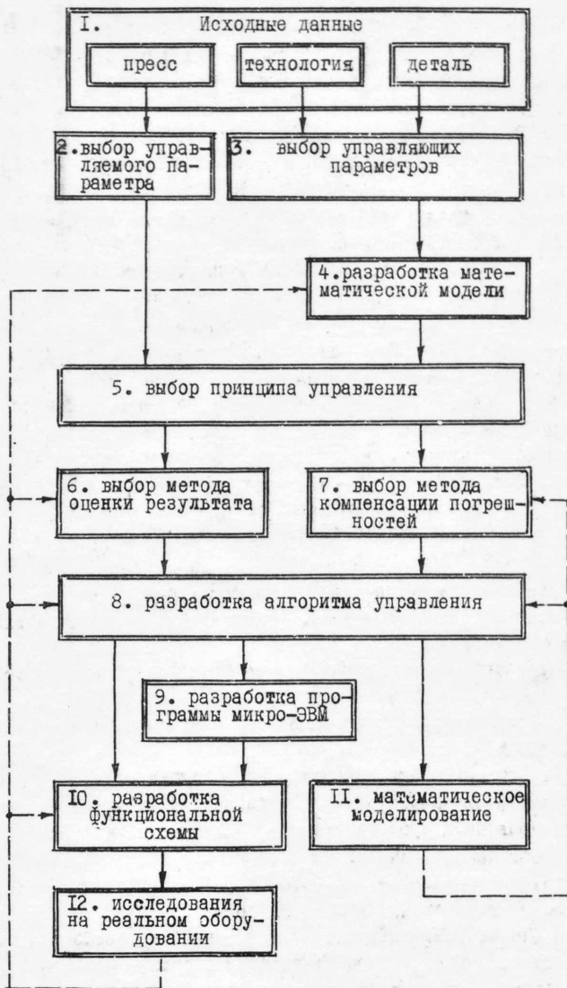
Рис. 3. Схема процесса проектирования системы управления энергией удара
