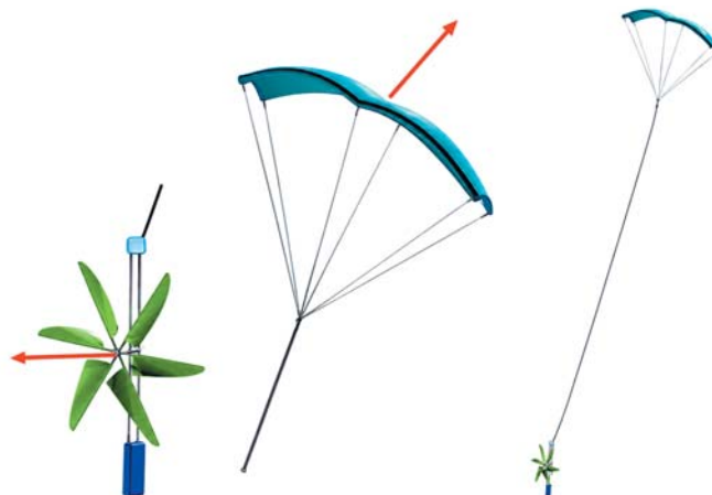
Рис. 17. Атмосферный зонд «Ветролёт» с тормозной роторной системой
