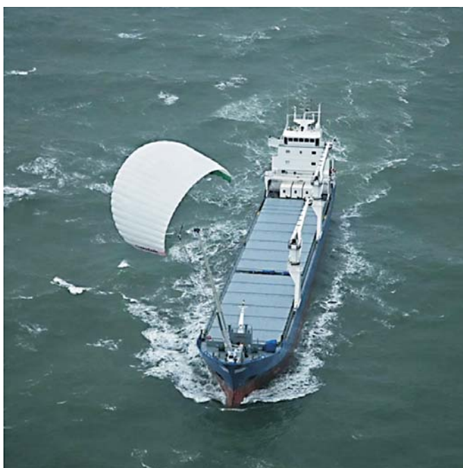
Рис. 8. Кайты для буксировки больших океанских контейнеровозов
