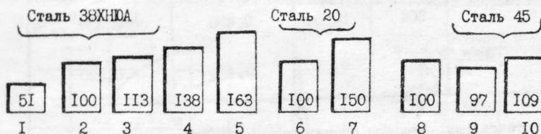
Рис.3. Сравнительная прочность (в процентах) соединений с натягом при сборке с охлаждением в зависимости от вида химико-термической обработки сопрягаемых поверхностей: I – механическая запрессовка, вал и втулка азотированы; 2,6,8 – без обработки; 3 – азотирован вал; 4 – азотирована втулка; 5 – азотирован вал и втулка; 7 – цементация вала и втулки; 9 – воронение вала; 10 – оксидирование вала (сборка соединений 2-10 осуществлялась с охлаждением)
