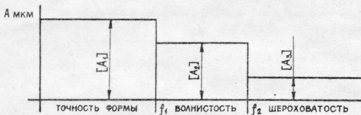
Рис. 1 Область работоспособности амплитуд составляющих частотного спектра радиальных колебаний шпинделя
