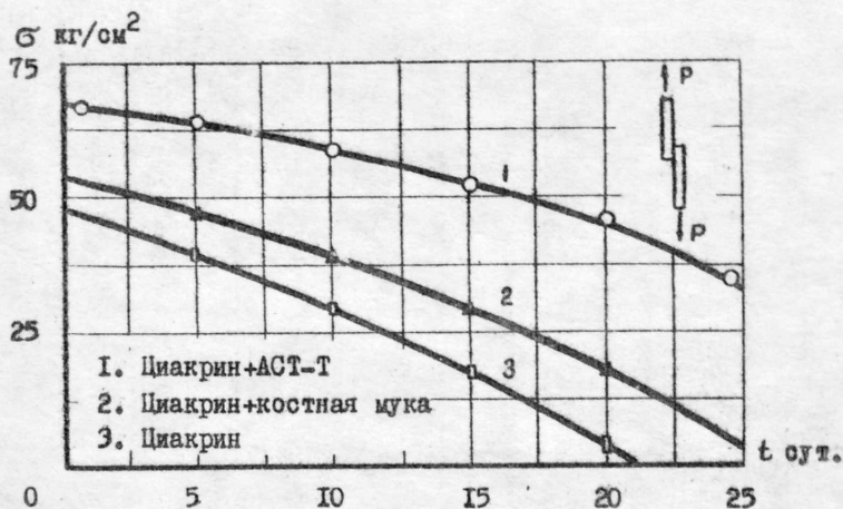
Рис.3. Влияние среды (вода) на прочность сварных соединений.
