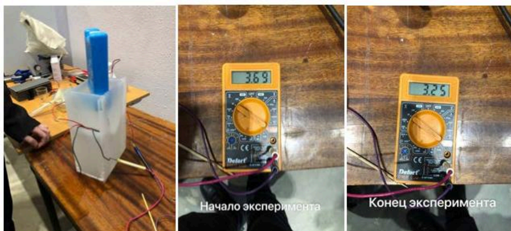
Рис. 1. Элемент Пельтье. Внешний вид и результаты эксперимента
