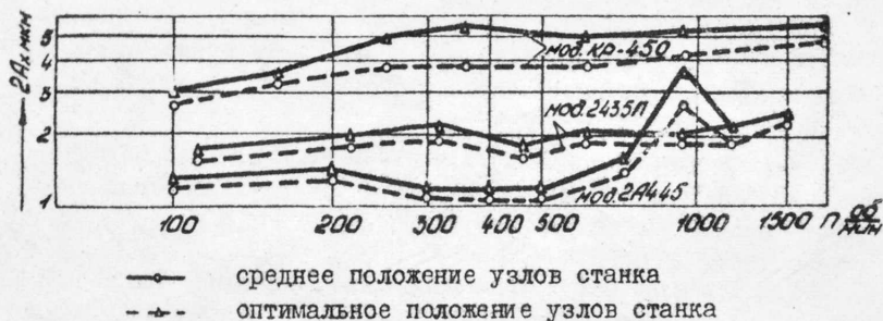
Рис.2. Влияние скорости вращения шпинделя и положения узлов станка на уровень колебаний при холостом ходе
