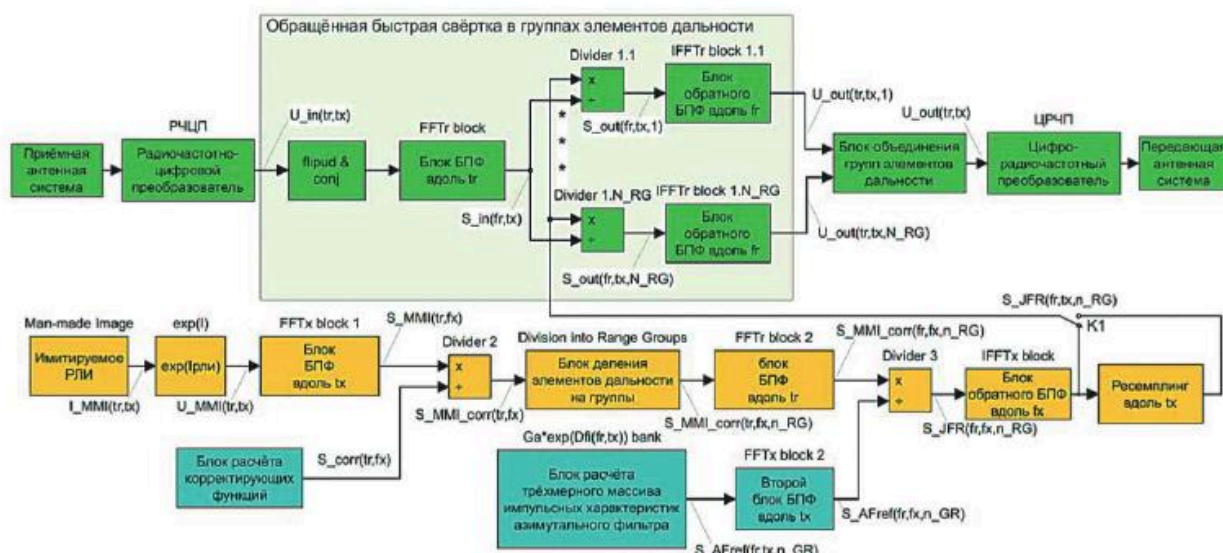
Рис. 8. Схема модели DRFM на основе обращенного Омега-k-алгоритма
