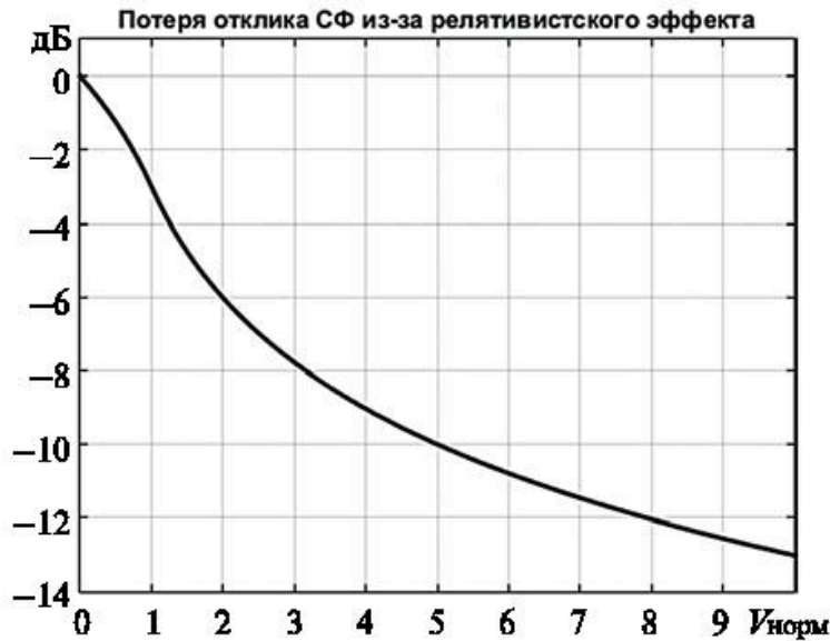
Рис. 3. Потеря отклика СФ из-за релятивистского эффекта при доплеровской обработке
