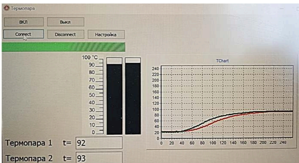
Рис. 2. Пример регистрации параметров процесса нестационарной теплопроводности в разработанной программе
