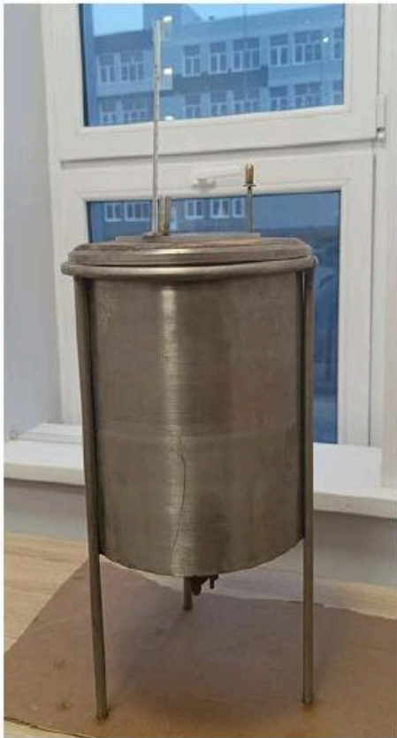
Учебный калориметр (калориметр Лавуазье — Лапласа)
