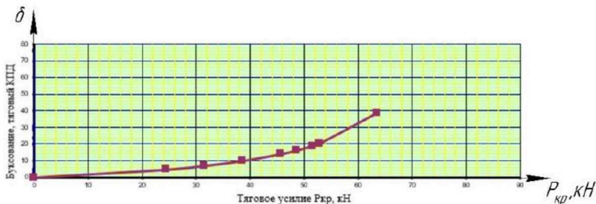
Зависимость буксования от тягового усилия на крюке
