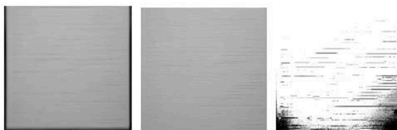
Рис. 2. Дефект «недостаточная экструзия»: полутоновое, медианно-фильтрованное, бинарное изображения
