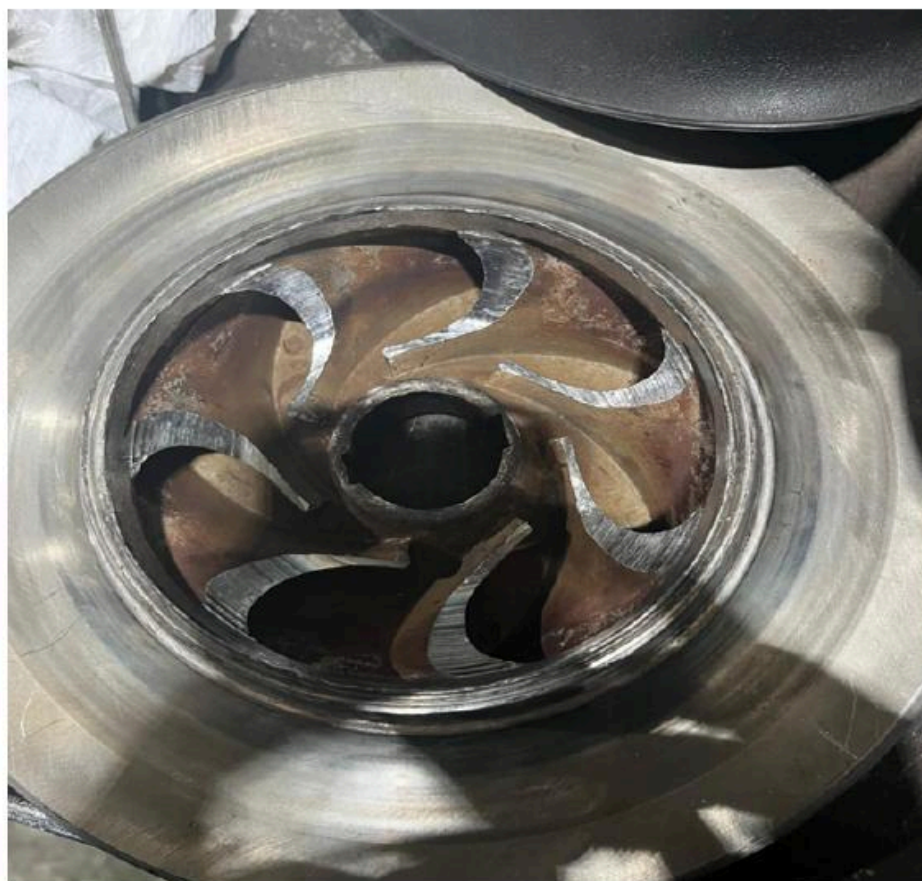
Рис. 1. Поврежденное рабочее колесо насоса
