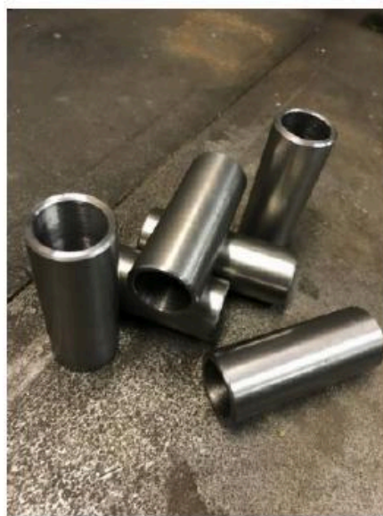
Рис. 1. Стальные образцы из стали 30 ХГСА
