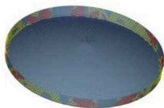
Расчетная САЕ модель и образец рефлектора антенны космического радиолокатора жесткого типа
