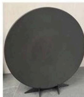
Расчетная САЕ модель и образец рефлектора антенны космического радиолокатора жесткого типа
