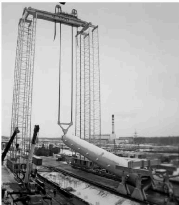
Рис. 1. Общий вид подъемно-транспортной системы B-SET
