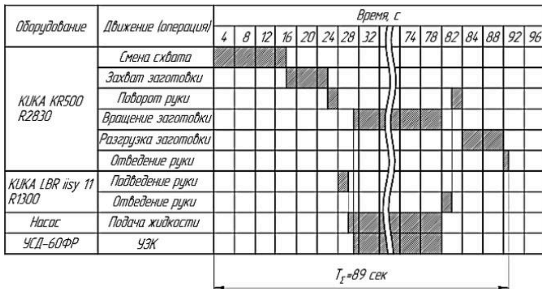
Рис. 4. Циклограмма работы оборудования (контроль сварных швов)
