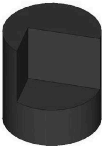
Рис. 2. Операция вычитания исходных тел
