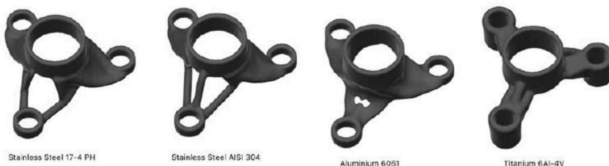
Рис. 1. Варианты конструкции фланца, сгенерированные в Autodesk Fusion 360
