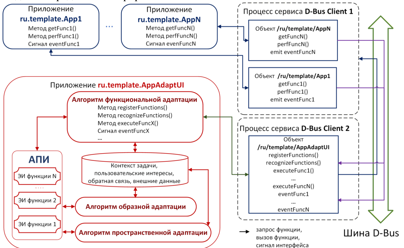
Рисунок 2 – Программная архитектура АПИ на основе сервиса межпроцессного взаимодействия D-Bus для ОС Аврора
