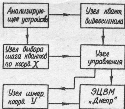
Рис. 2. Блок-схема сопряжения устройства ввода с ЭВМ.
