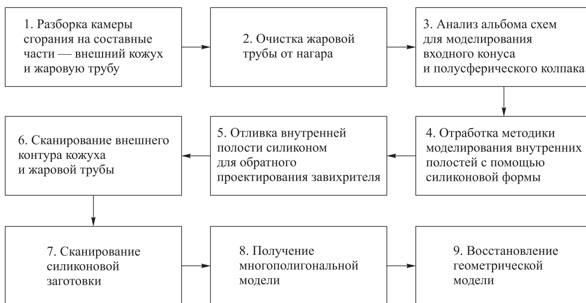
Рис. 2. Блок-схема алгоритма процесса ОП камеры сгорания ТРД ВК-1
