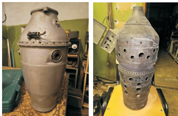
а б Рис. 3. Внешний вид кожуха (а) и жаровой трубы (б) КС
