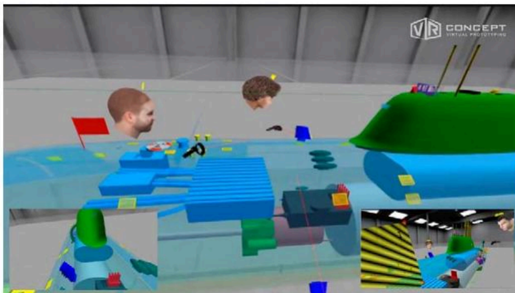
Рис. 1. САПР модель подводной лодки в многопользовательском VR
