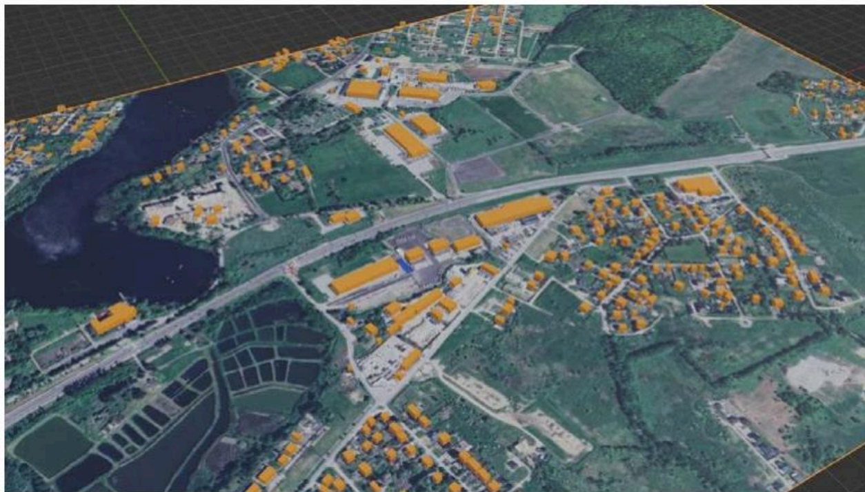
Рис. 1. Идентификация и моделирование новостроек в ПО Blender на космическом снимке
