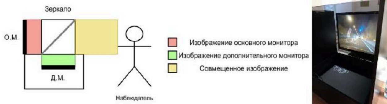
Рис. 1. Принципиальная схема собранного проекционного HUD дисплея
