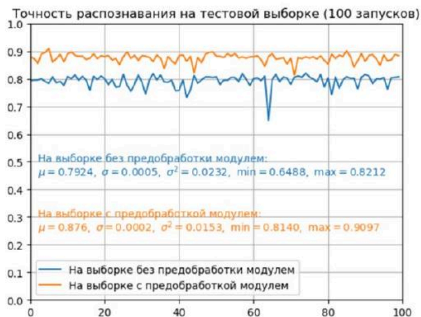
Рис. 4. Точность распознавания образов обученными нейронными сетями на тестовой выборке
