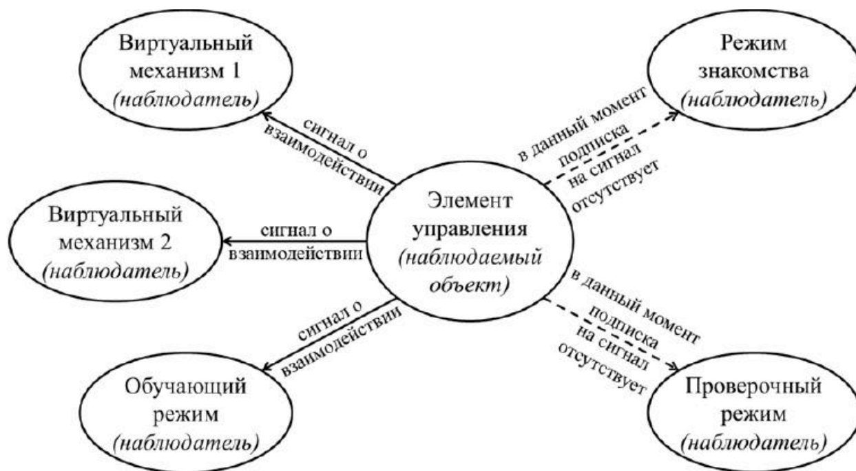
Рис. 2. Схема шаблона «Наблюдатель» для оповещения о взаимодействии с элементом управления
