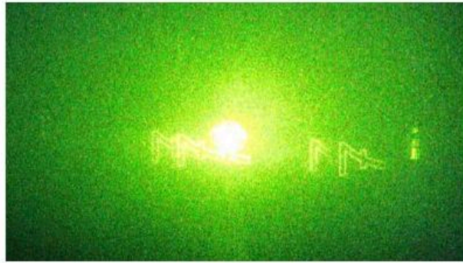
Рис. 2. Наложение изображений при параллельном расположении плоскости ПВМС и волновода
