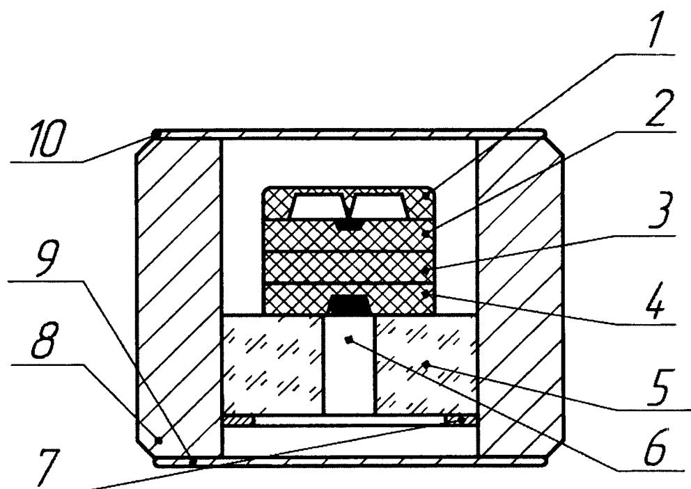
1 – кристалл кремния с кантileвер-иглой; 2 – кристалл кремния с областью пористого слоя не более 50мкм; 3 – кристалл монокристаллического кремния; 4 - кристалл кремния с областью пористого слоя не менее 60мкм; 5 – стеклянная подложка; 6 – отверстие в стеклянной подложке; 7 - рамка; 8 – корпус; 9 – нижняя крышка; 10 – верхняя крышка
