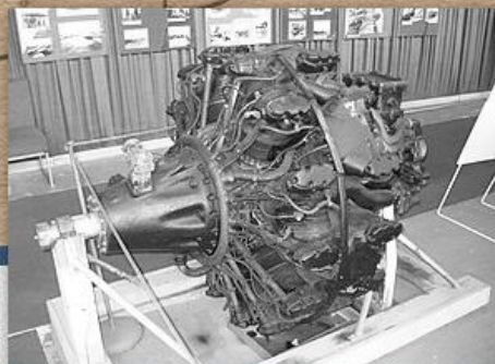
АШ-82 (М-82), советский авиационный поршневой двигатель внутреннего сгорания
