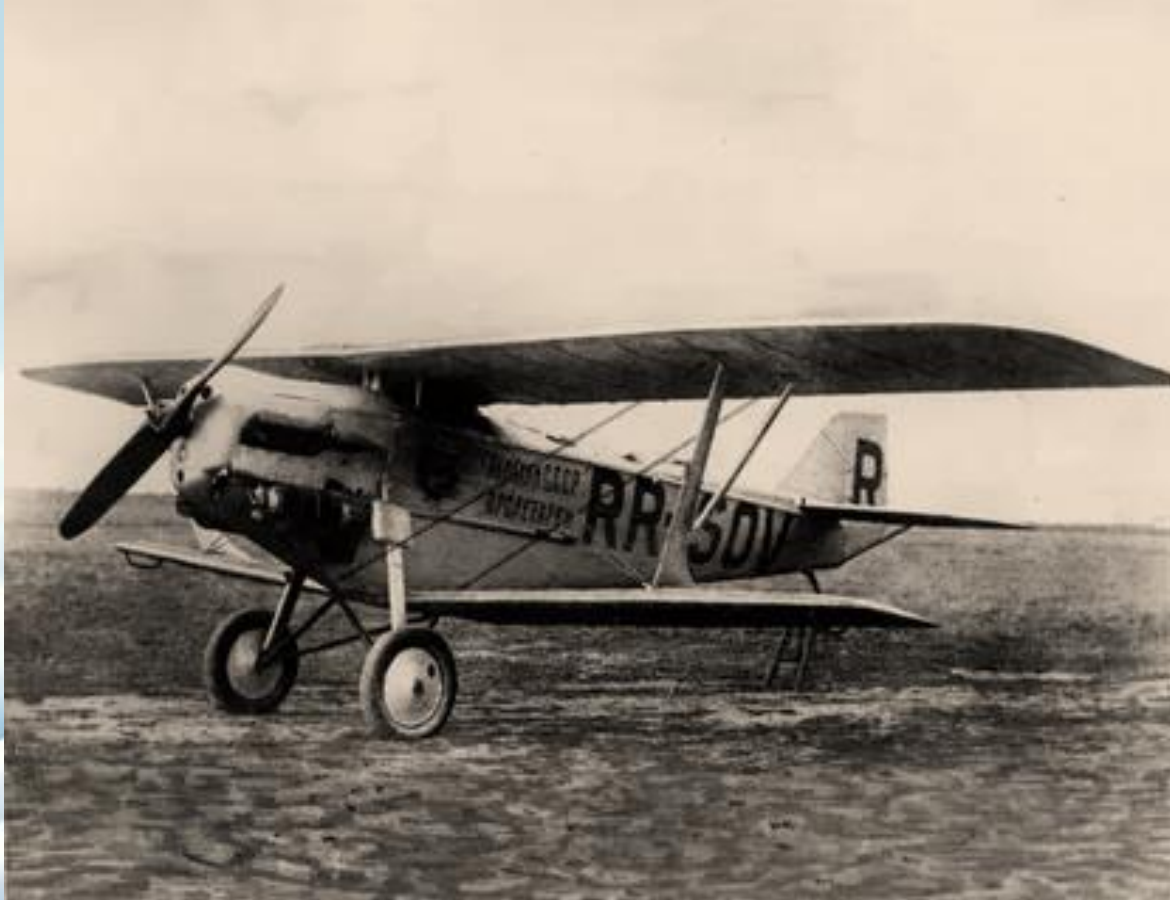
АНТ-3 Цельнометаллический двухместный разведывательный биплан
