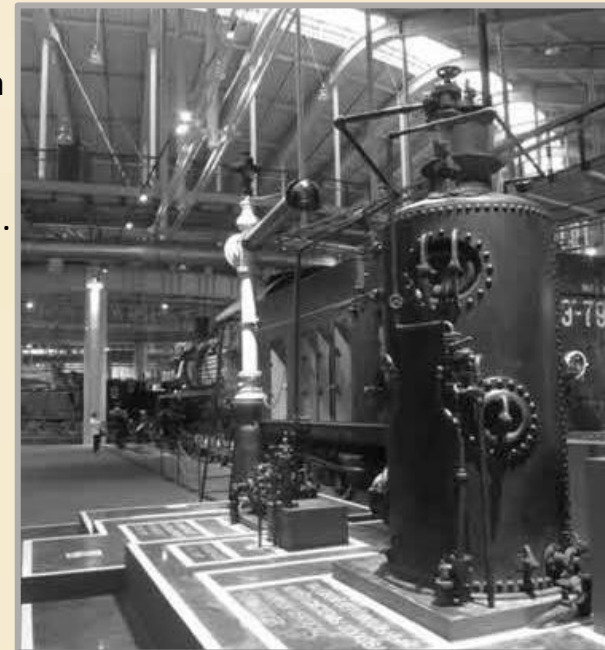
Вертикальный водотрубный паровой котёл системы Шухова. Музей железных дорог России. Санкт-Петербург
